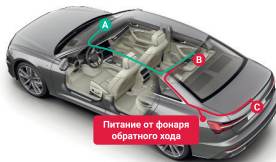
Рекомендуемое место монтажа второй камеры
